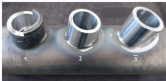
WAAM-generierte Rohrstutzen in unterschiedlichen mechanischen Bearbeitungsphasen.
