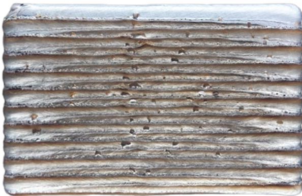
Beispiel für Bahnplanungsdaten, hier Volumenaufbau eines Quaders.
