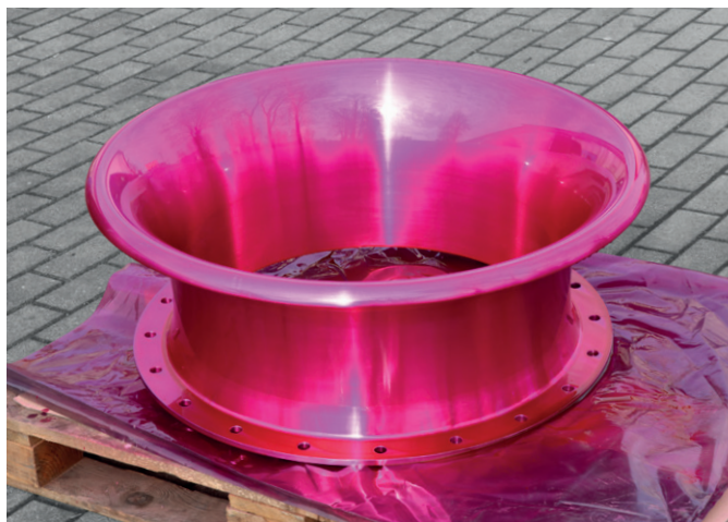
| Einlauftrompete mit Farbeindringmittel für die Farbeindringprüfung (PT) (Bild: SLV Halle)
