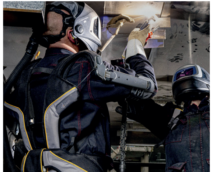
Exoskelette stützen den Oberkörper von Schweißern und beugen damit Muskel-Skelett-Erkrankungen vor. (Bild: Fraunhofer IPA)
