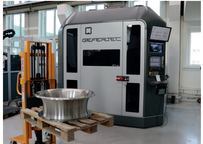
| Einlauftrompeten-Prüfstück und GEFERTEC Anlage arc405 (Bild: SLV Halle)
